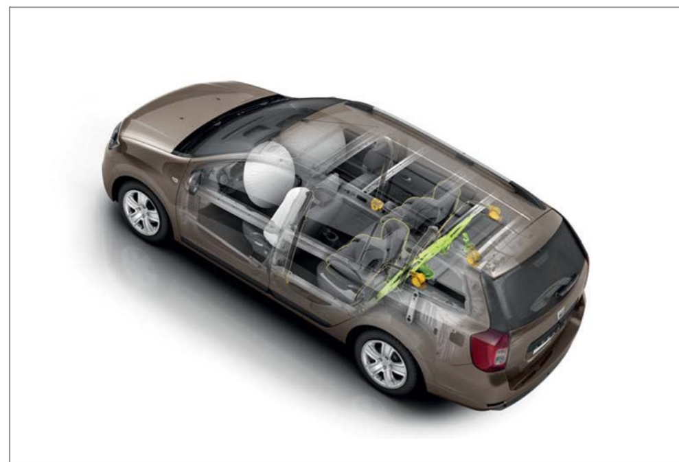
Proteção: Estrutura reforçada, airbags frontais e laterais dianteiros, sistema de fixação ISOFIX nos lugares laterais traseiros.
